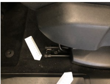
Vloerbekleding linksvoor schroeiplekken
