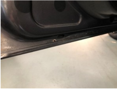
Front left door - Rust formation
