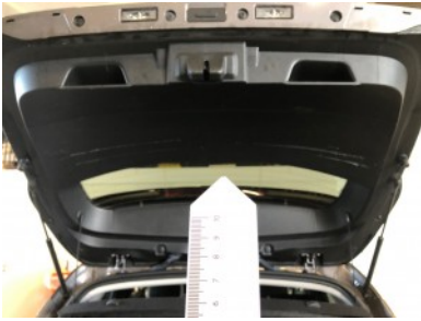
Achterklep bekleding krassen
