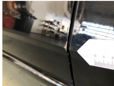
LV portier - Roestvorming
