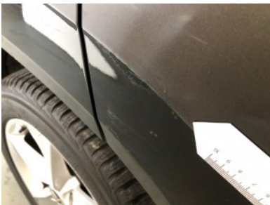
RA portier - Lakherstel
