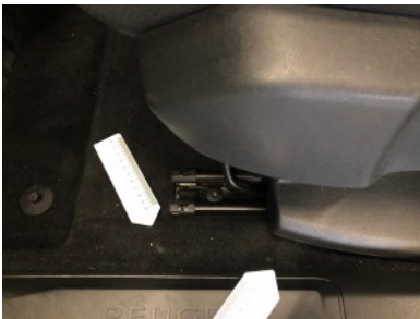
Vloerbekleding linksvoor schroeiplekken
