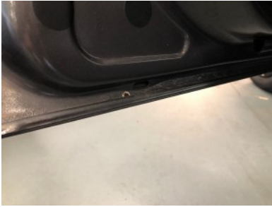
LV portier - Roestvorming
